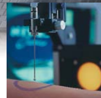
«Kontaktwinkelmessung zur Bestimmung der Wasserfestigkeit von Lichtschutzprodukten.»
